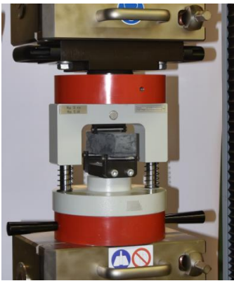
Dispositif pour essais de flexion 3 points sur prismes 40•40•160 mm type BV-10
