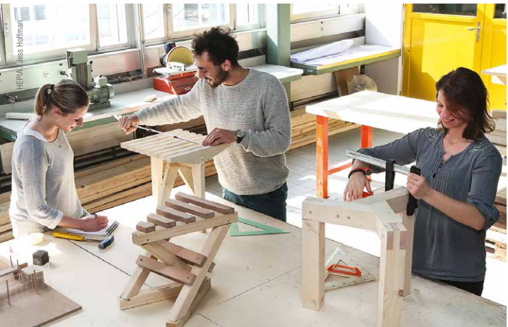
Atelier de maquettes, réalisation d'un tabouret en bois sans colle ni vis, tout un équilibre.
