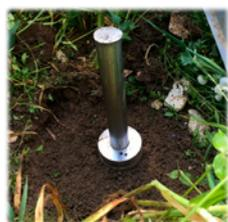
Figure 1 : Prélèvement d'échantillon non remanié pour déterminer la densité apparente (Da) du sol.
