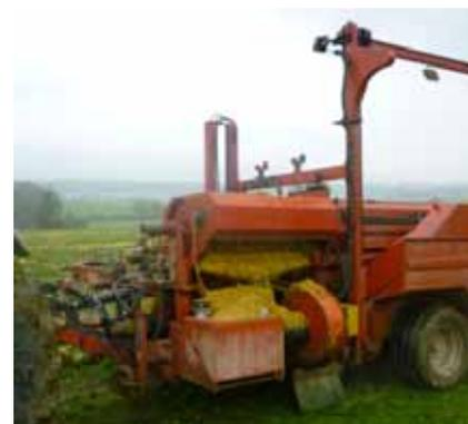
Au devant, la turbine aspire une grande quantité d'impuretés. À l'arrière, le tank de stockage peut contenir 1200 g de graines.
