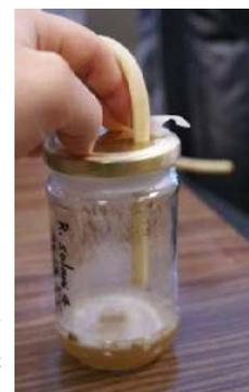
Durant l'analyse, l'une des chambres de test reste en contact avec l'air ambiant tandis que la prise d'air de l'autre est introduite dans le bocal et aspire l'atmosphère de l'échantillon. Le signal de référence (ou signal de fond) émis par la première chambre
