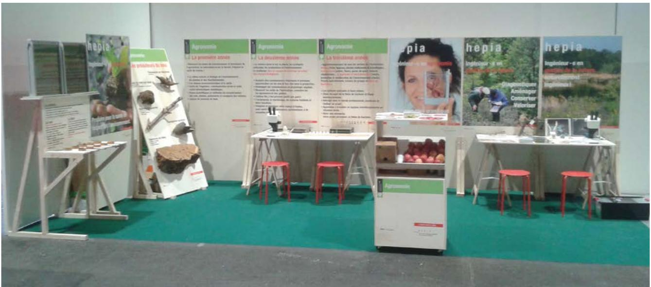
Construit en épicias, dans l'idée d'avoir une unité de matériau, les modules sont montés à l'aide de vis à ailettes, tout se démonte et se met à plat, pour optimiser le transport. Un panneau par année présente les grandes lignes de la formation. 2 panneaux avec des photos illustrant la filière. Les animations sur le stand ont été conçues comme
