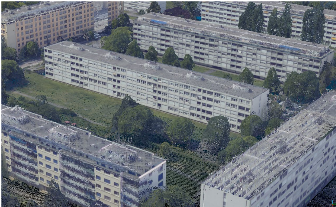
Figure 10. Modèle 3D texturé des façades visualisées conjointement avec le nuage de points 3D généré par photogrammétrie à partir d'images aériennes (sol, végétation et toit).
