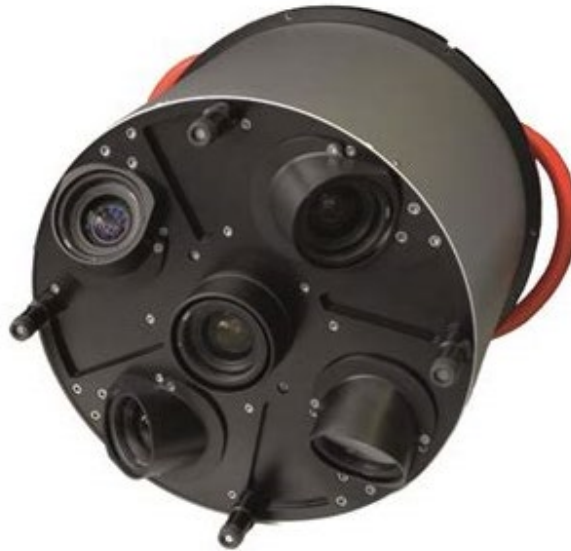
Figure 8. Capteur imageur aérienne permettant des prises de vues obliques.
