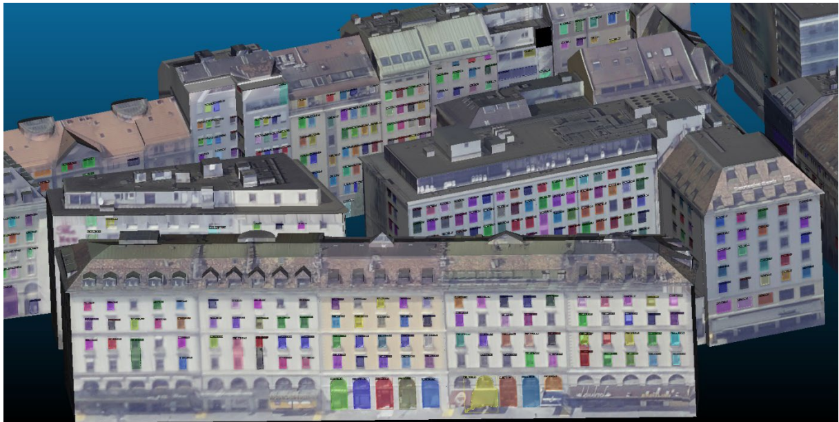
Figure 12. Résultat de l'extraction automatique des fenêtres sur les ortho-images de façades, reprojétés dans le modèle 3D des bâtiments. Exemple sur le quartier des Bergues.
