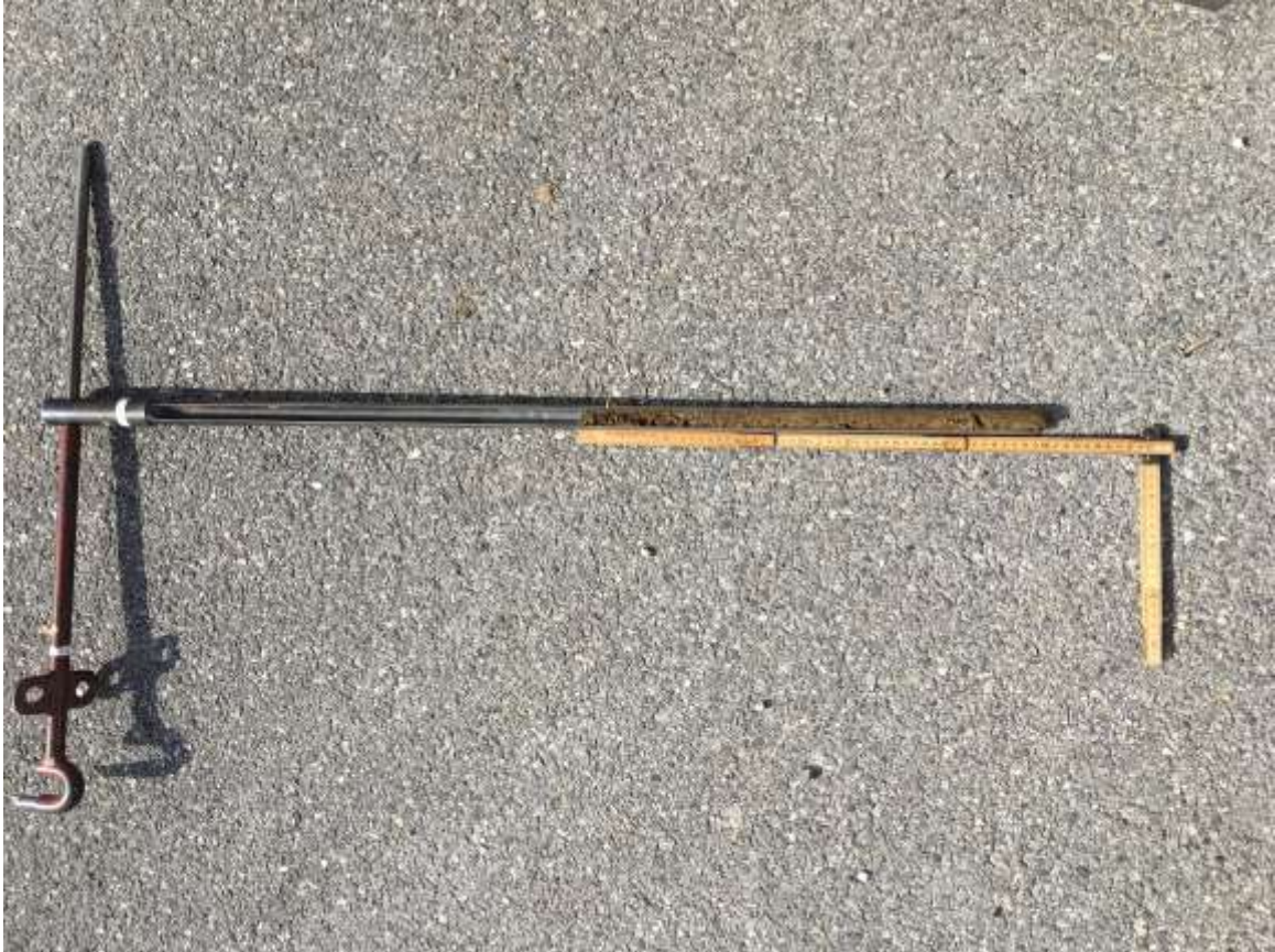
Figure 5 (ci-dessus) et 6 (ci-dessous) : Mesure de profondeur sur le carottage.
