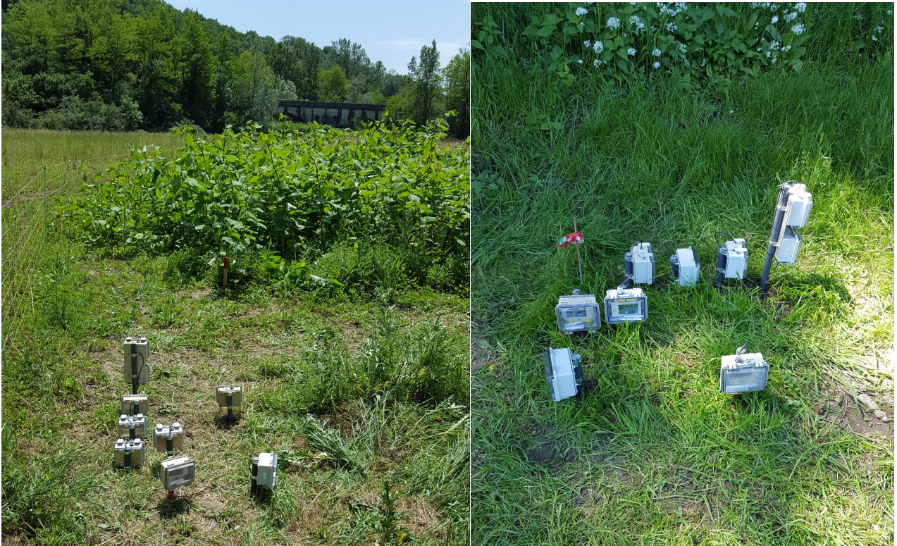
Figure 8. Mise en place d'un "cluster" de loggers sur les site SU_P1 et VS_P1
