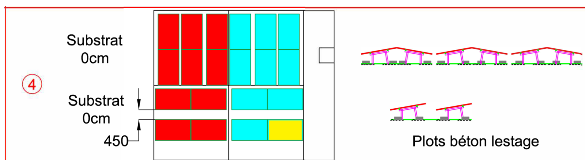
Figure 10 : calepinage et coupe de l'alvéole n°4
