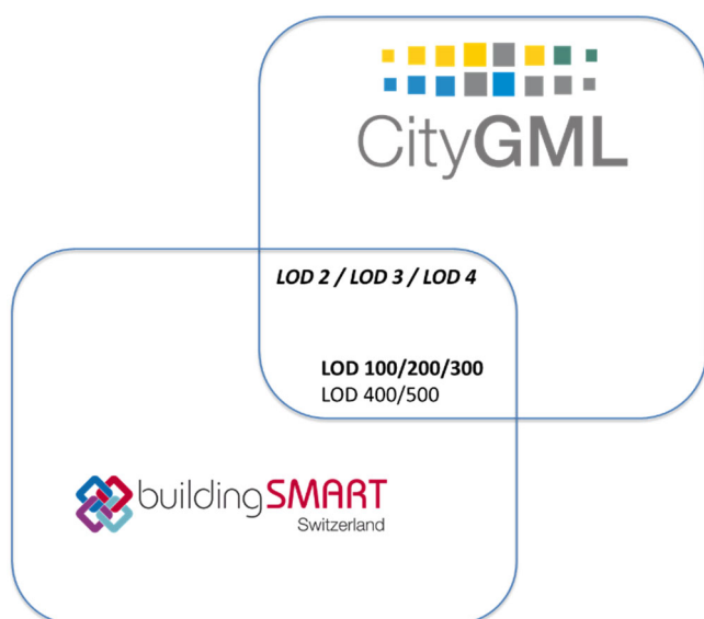
Figure 25 : « Semantic overlap » entre IFC et CityGML
