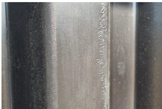
Figure 8 : Photo illustrant un cas de tôle avec de la rouille blanche © Montana
