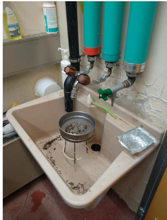
Figure 3 : Tamisage pour la séparation des grossiers.
