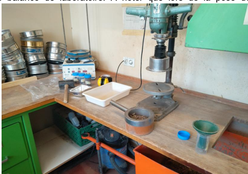
Figure 2 : Plan de travail lors de l'étape du broyage, avec les matériaux concassés dans le tamis, prêts à être broyés.
