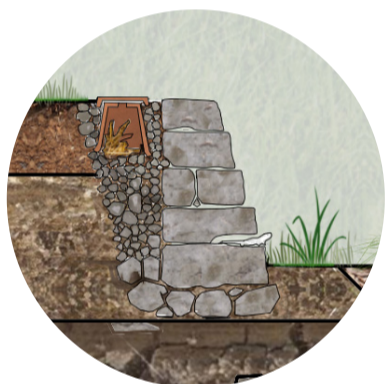
Muro in pietre a secco e cavità
