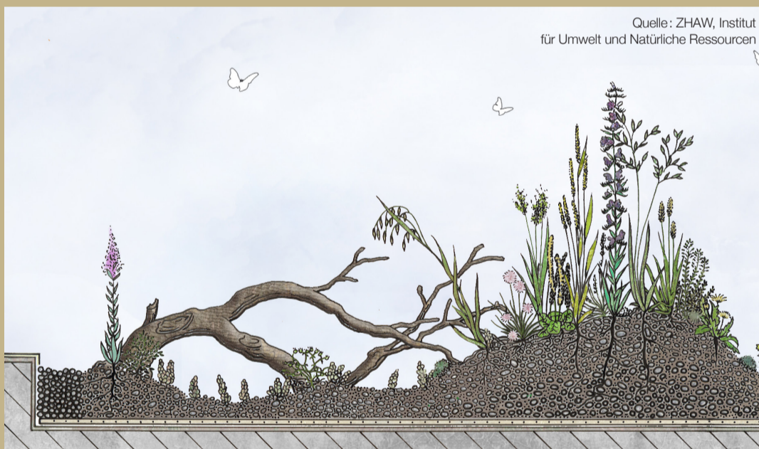
Schematischer Schnitt (nicht massstabgerecht) einer extensiven Dachbegrünung mit Mikrotopographie und Trockenholz für die Insekten.
