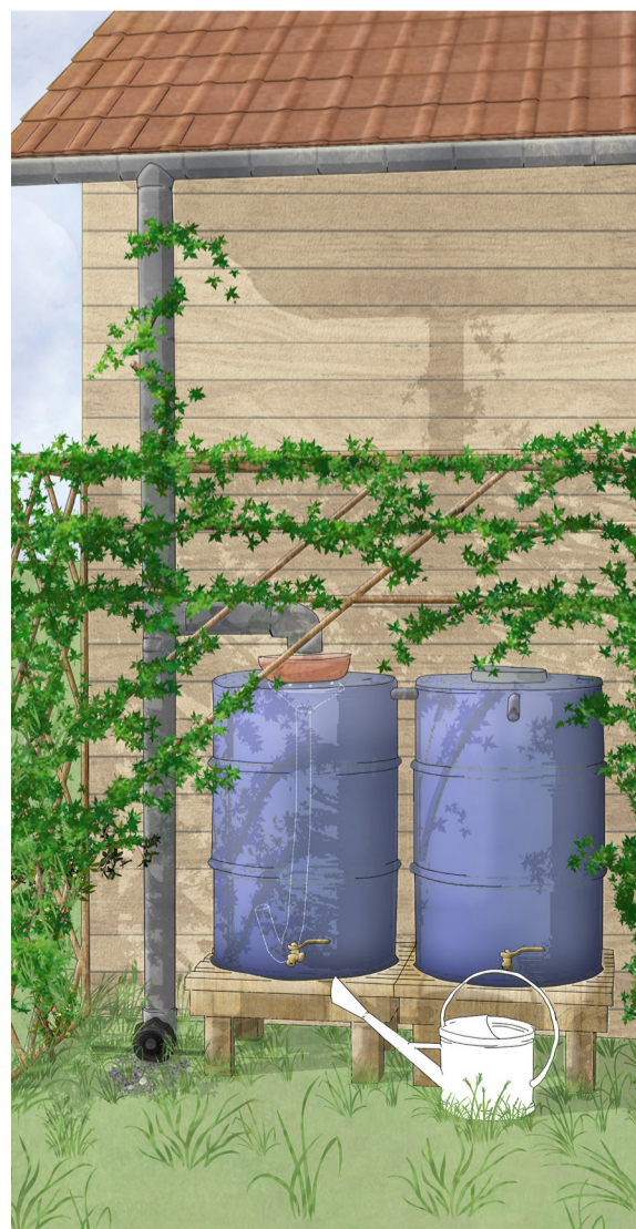
Système de récolte des eaux du toit avec séparation des eaux troubles.
