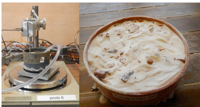
Figure 2. A : Courbe de désorption : matériel de mesure, B : désorption des éléments grossiers (> 2 mm) inclus dans un lit de microbilles.
