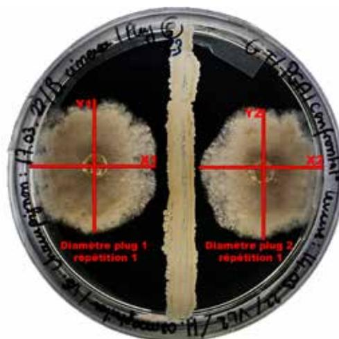
Figure 2. Dispositif expérimental avec au centre de la boîte de Petri le trait de levure, 2,5 cm et à gauche et à droite de ce trait les explants mycéliens du champignon pathogène (5 mm de diamètre) qui, sur la photo se sont développés. En rouge les paramètres mesurés pour calculer la croissance radiale et, *in fine*, le taux d'inhibition.
