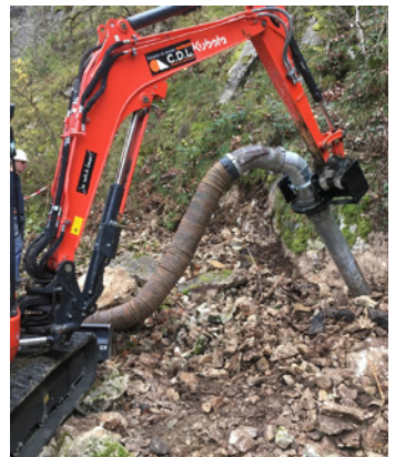
◀ Concassage-criblage-tri des rhizomes en berges - © N. Balverde
