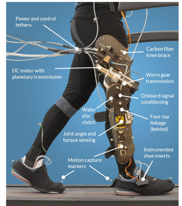
Dispositif électromécanique mobile utilisé pour perturber le genou. (Tucker et al. 2017) Couple maximal : 40 Nm
