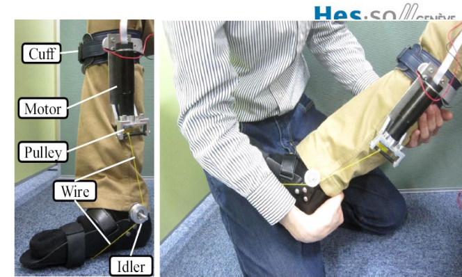
Dispositif électromécanique mobile utilisé pour simuler des contraintes sur la cheville. (Okumura et al. 2015) Couple maximal : 22,3 Nm
