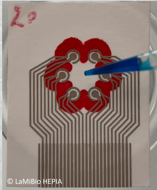
Impression multicouche d'encres conducteur 1 – isolant UV – conducteur 2
