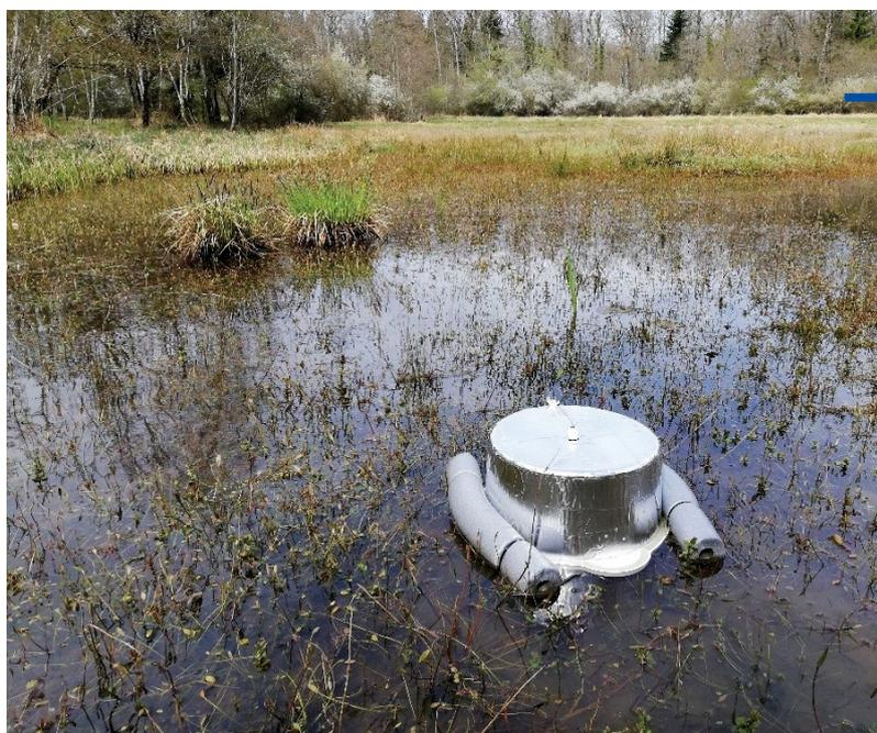
*Une « soucoupe flottante » installée à la surface d'un étang pour mesurer les émissions de gaz à effet de serre.
