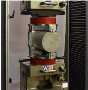
**Dispositif pour essais de fendage de cylindre en béton (essai brésilien) type SPV 200**
