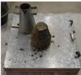
Équipement pour la mesure de la consistance des bétons frais.
