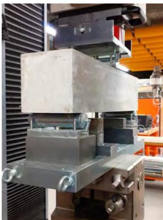
**Dispositif pour essais de flexion 3 points renforcé pour essais sur béton fibré ou bfup**
