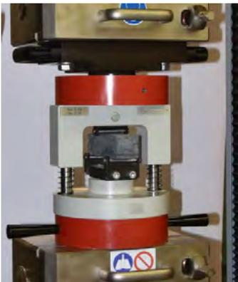
**Dispositif pour essais de flexion 3 points sur prismes 40•40•160 mm type BV-10**
