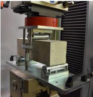
**Dispositif pour essais de flexion (3 et 4 points) type BV-150**
