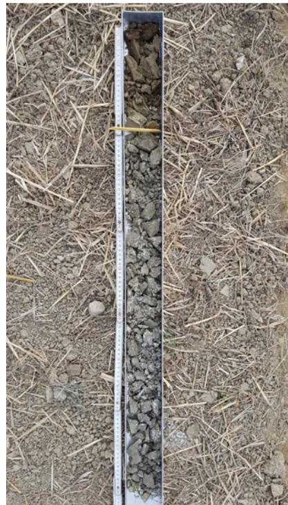
Sondage à la tarière posé dans une gouttière. A l'aide d'un mètre, on indique la profondeur. Source: photo personnelle
