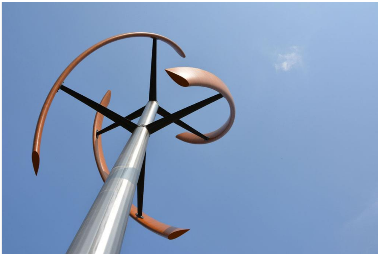
Hercules, aerogeneratore eolico in fibra di carbonio e acciaio inox di Enessere
