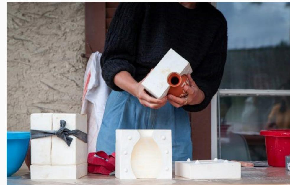
Démonstration de l'utilisation d'un moule en plâtre à plusieurs parties
