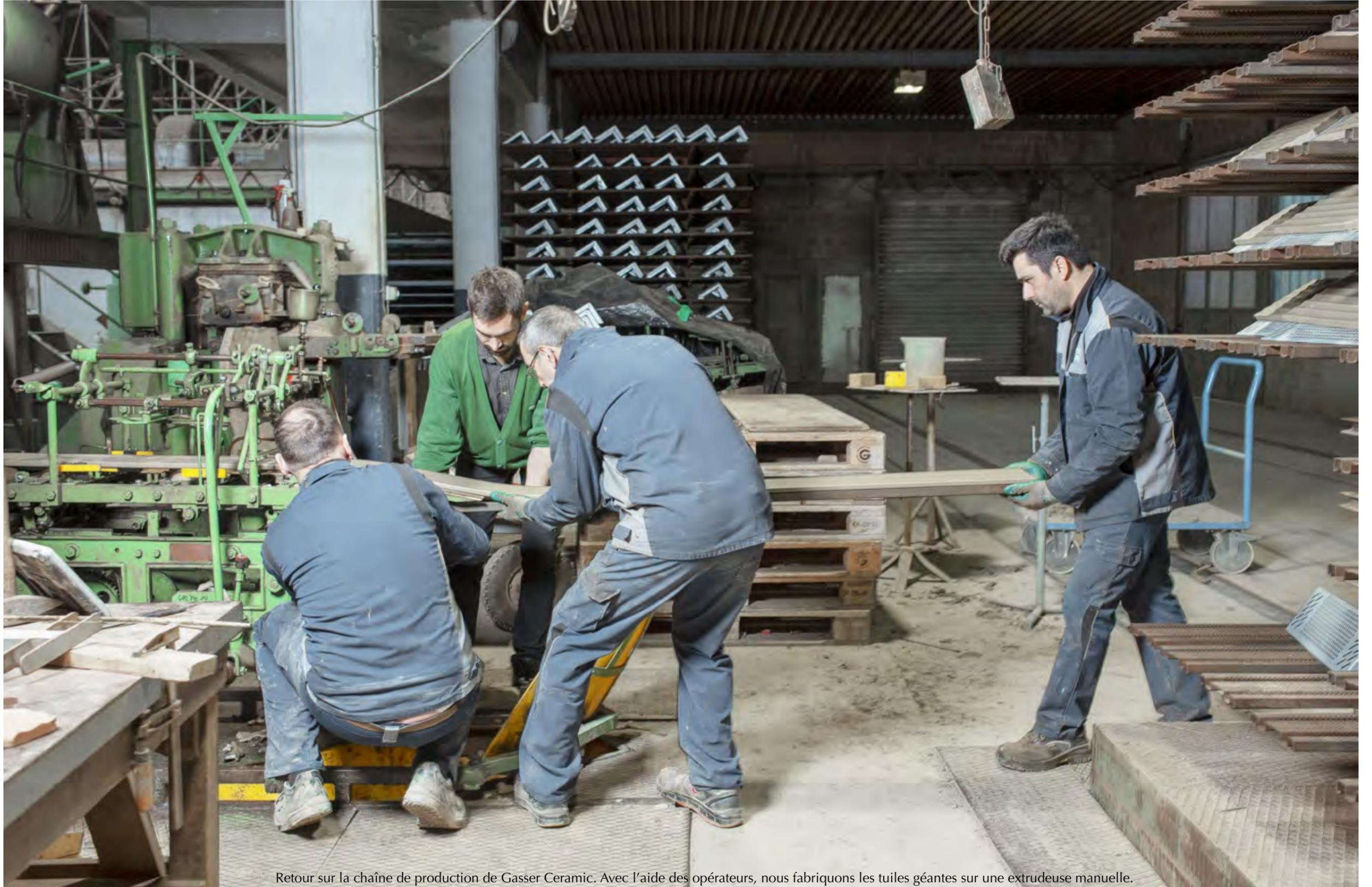
Retour sur la chaîne de production de Gasser Ceramic. Avec l'aide des opérateurs, nous fabriquons les tuiles géantes sur une extrudeuse manuelle.
