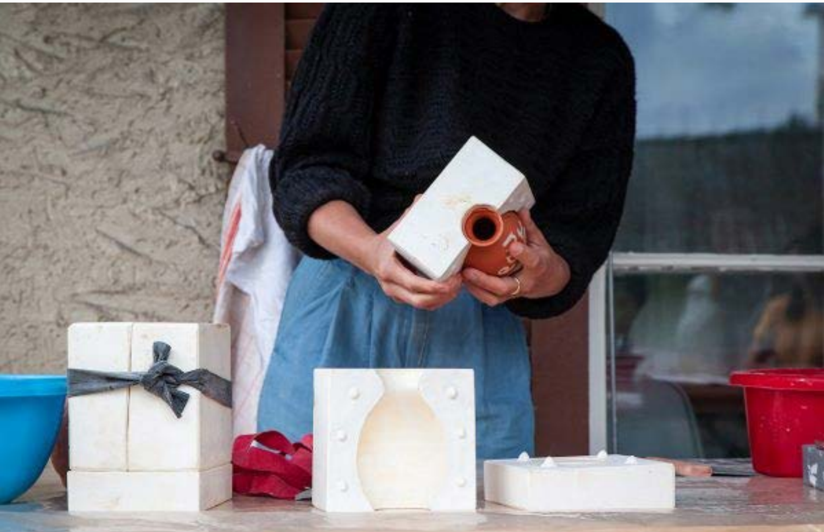
Démonstration de l'utilisation d'un moule en plâtre à plusieurs parties © Aline Morvan
