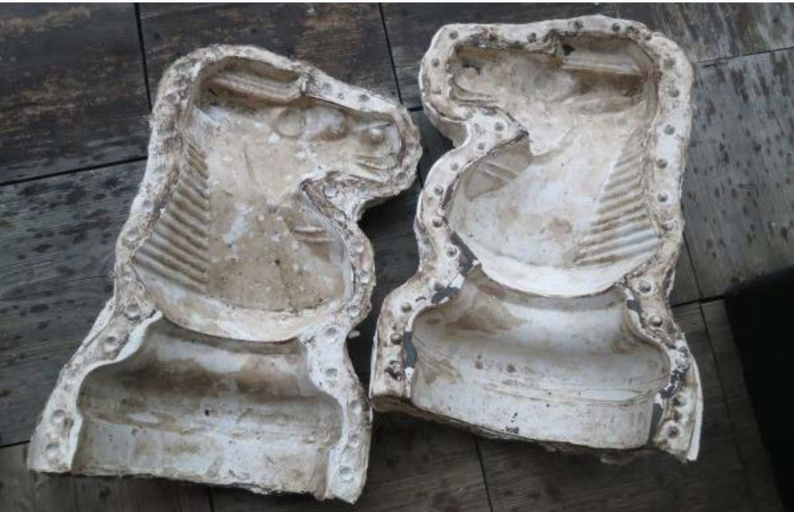
Moule en silicone en deux parties, avec son contre-moule en plâtre. © Aline Morvan
